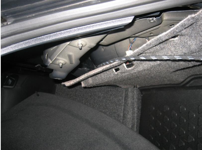
Das Kabel wird hinter der Filzverkleidung entlang geführt. Dies kann einfach reguliert werden, indem die Verkleidung für die Demontage der Rückleuchten (Filzabdeckung) abgenommen wird. Die Innenraumverkleidungen alle wieder befestigen. Die Verlegung des Kabels im Innenraum ist somit abgeschlossen. Bitte das Kabel so positionieren, dass es bei der Abnahme der Stoßstange griffbereit ist.
