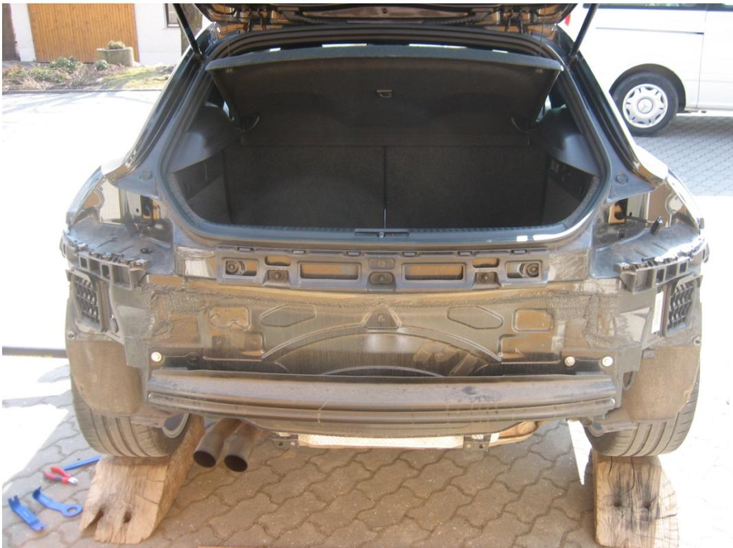
Die abgenommene Stoßstange hat zwischen den beiden Kennzeichenleuchten eine vorgestanzte Form der Kamera:
