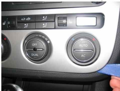
Schrittweise alle Clips lösen und am Schluss die Dekorblende abziehen.
