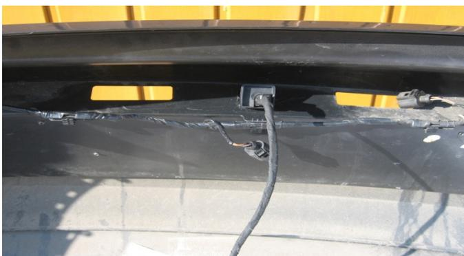
Das Kabel der Kamera wird per Kabelbinder oder Panzertape entlang des PDC/Kennzeichenkabels gelegt, damit es nicht frei rumfliegt unter der Fahrt.
