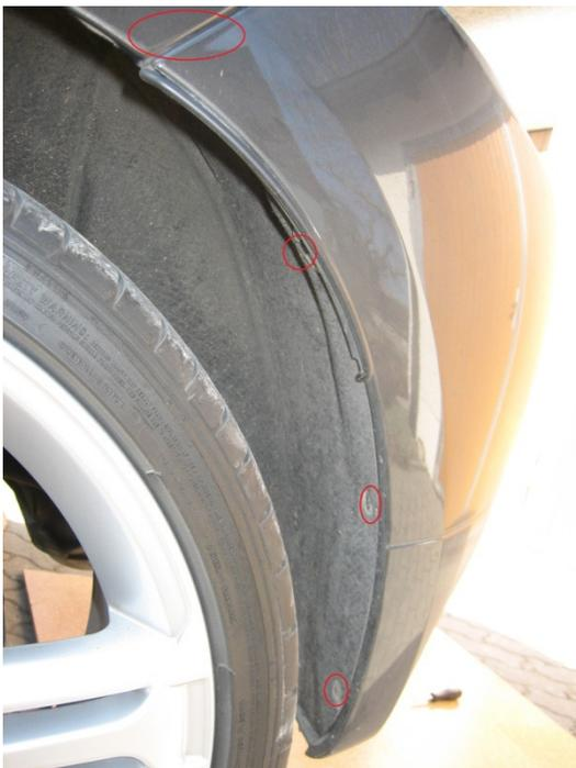
Dieses Fahrzeug ist nur mit gekürzten Federn tiefer gelegt und somit konnten mit dem Anheben problemlos per Ratsche die drei ersichtlichen Schrauben entfernt werden.
