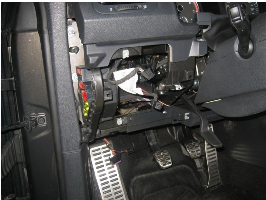
Nun einen passenden Massepunkt suchen und den Sicherkasten lösen (zwei Schrauben, eine oben, eine unten, dann die Abdeckung öffnen und ein Dauerplus messen und einpinnen; Je nach Ausstattung unterschiedlich, deshalb lässt sich keine Aussage über einen sicheren freien Steckplatz treffen).
