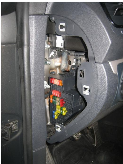
Als nächstes muss die Verkleidung, welche Lichtschalter, Armaturenbeleuchtung und das kleine Ablagefach enthält, entfernt werden.
