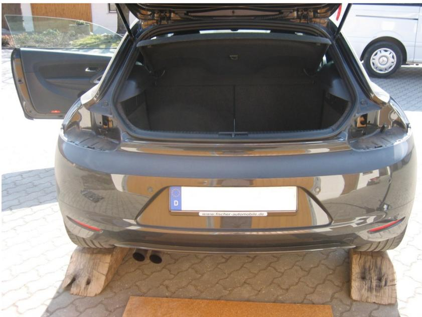
Auf dem Bild sind bereits die Rückleuchten entfernt worden. Zur Demontage: Filzabdeckung abnehmen im Innenraum, dann die Plastikfederschraube abschrauben und schon kann man die Rückleuchte zu sich ziehen. Nun noch abstecken und die Rückleuchte beiseite legen.
