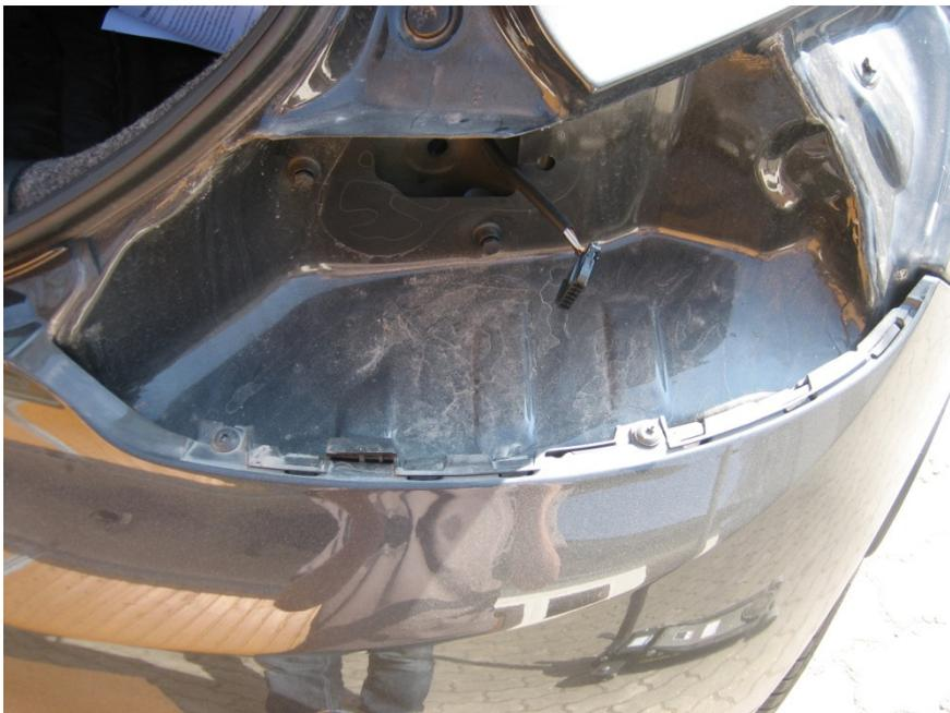
Auf der Unterseite der Stoßstange befinden sich pro Seite wieder 2 Schrauben.
