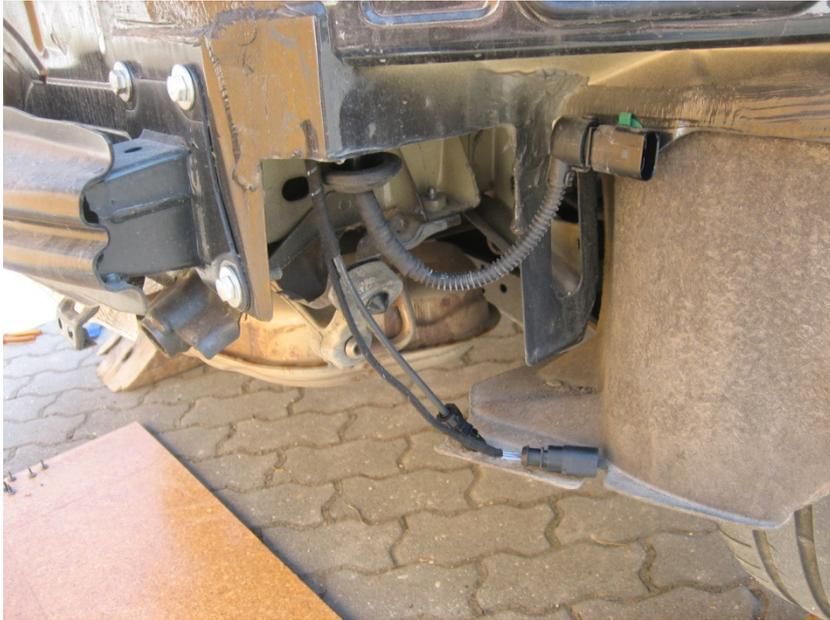
Das Kabel am besten durch einen neuen Eingang durchziehen und den Stopfen wieder montieren.
