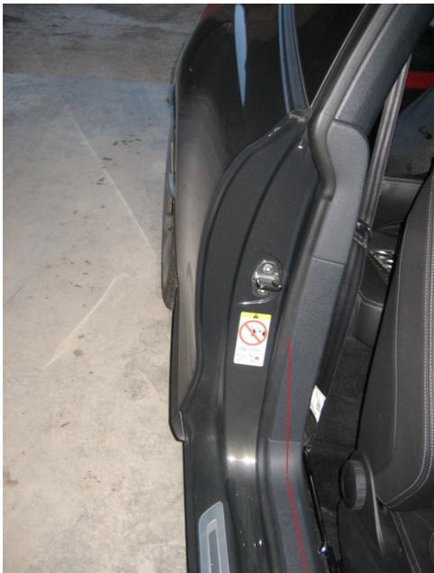
Die Einstiegsverkleidung mit einem Plastikkeil abklipsen und das Kabel bis zur B-Säule unten rum ziehen. Die Verkleidung dafür kann einfach geöffnet werden. Dann mit einem Draht von der Kofferraumseite aus das Kabel entlang ziehen. Um das Kabel in die rechte Seite des Kofferraums zu bekommen, muss die rechte Kofferraumverkleidung demontiert werden.
