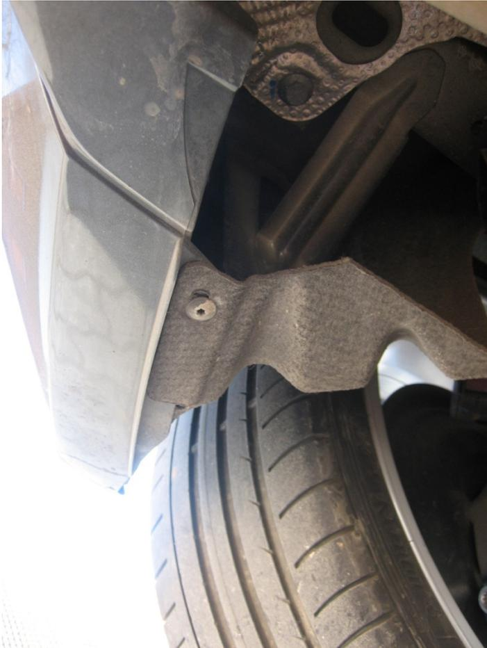
Dann wendet man sich dem Radkasten zu. Falls das Auto nicht zu tief ist, kann man, wenn das Auto aufgebockt ist, mit dem Wagenheber nochmals das Auto heben, dass der Radkasten leichter zugänglich ist und man die Felge nicht abnehmen muss. Bei Gewindefahrwerken kann es sein, dass eine Demontage der Felgen unumgänglich ist.
