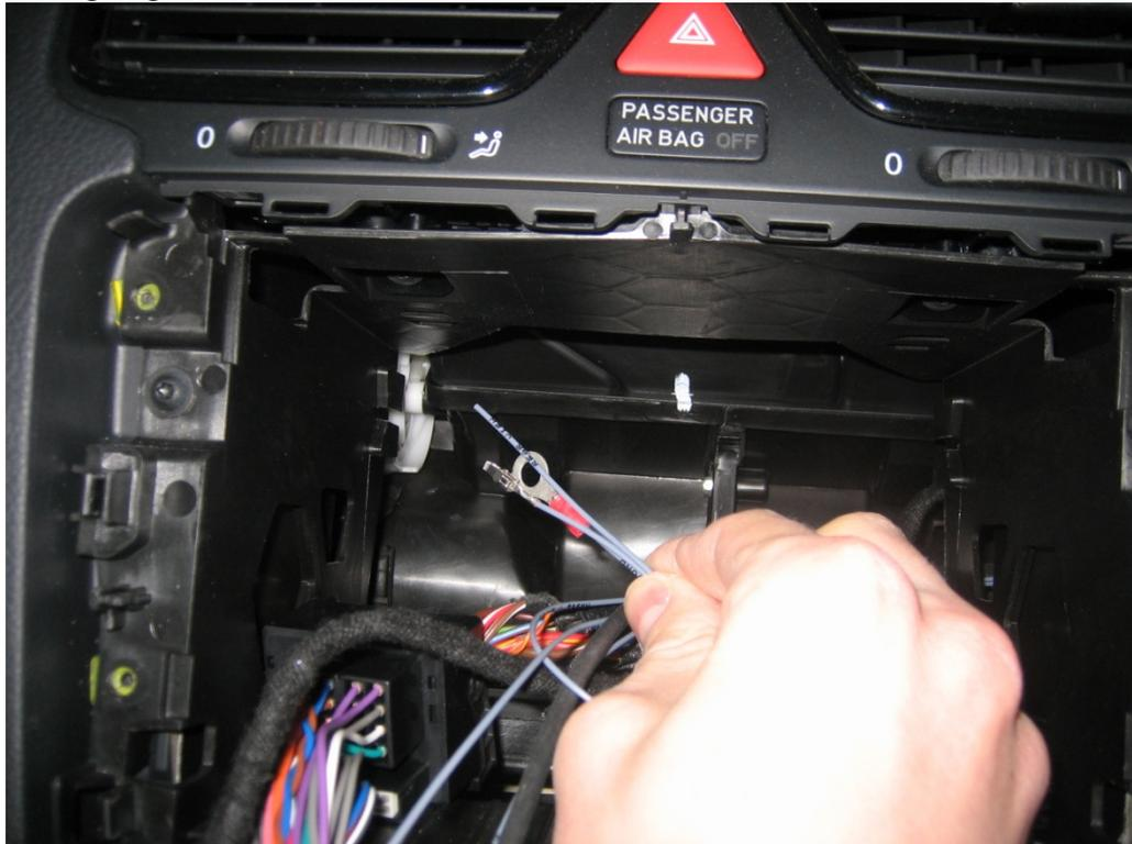
Das mit Dauerplus beschriftete Kabel muss dann bis zum Sicherungskasten im Innenraum gezogen werden und wird mit an eine freie Dauerplus stelle mit separater Sicherung eingepinnt (5A). Für das Massekabel bitte einen geeigneten Massepunkt suchen.
