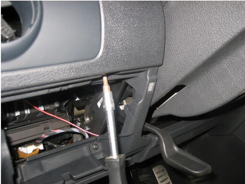
Insgesamt sind es 5 Schrauben. Drei beim Ablagefach, eine beim Lichtschalter und eine beim Kombiinstrument.
