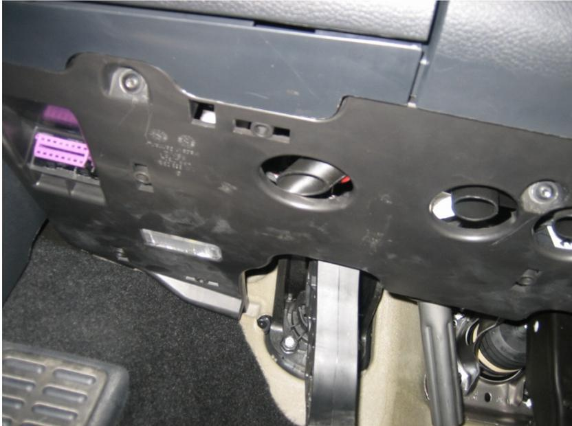
Dazu müssen die beiden Torxschrauben entfernt werden und der OBD-Stecker sowie der Stecker für die Fußraumbelichtung (falls vorhanden) ausgeklipst werden. Der OBD-Stecker ist auf der Unterseite mit einem Klip und auf der Oberseite mit zwei Klips befestigt. Dann kann die Fußraumverkleidung abgenommen werden.
